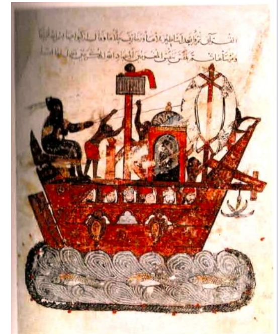
Afbeelding van een Perzisch schip uit de 12e eeuw, met ankervloei en aangehangen roer...
