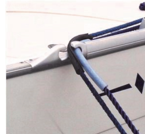
'Om landvasten tegen schavielen te beschermen zijn stukken slang een prima oplossing'
